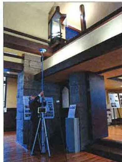
講堂2階席に高所点検カメラ「たかみ君」を伸ばすデモンストレーション(イング)
